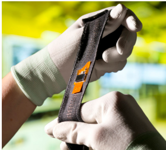
Flexibles Sensorpflaster zur Integration in Textilien. ©Fraunhofer EMFT/Bernd Müller
